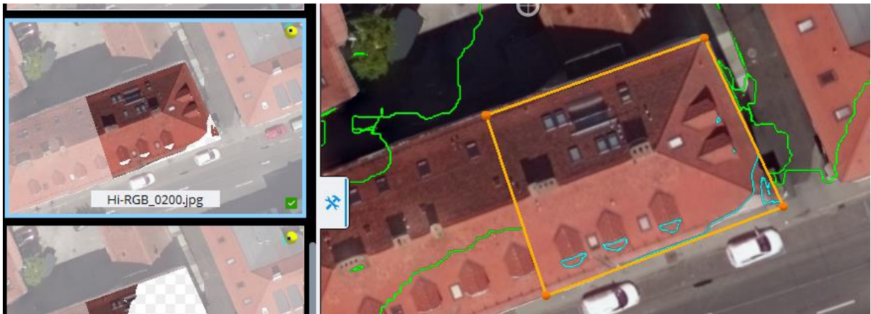
그림 1 녹색 선은 정사 사진 모자이크의 현재 영상 경계선입니다. 청록색 선은 선택한 이미지를 다각형 내부에 적용하면 도입되는 새로운 영상 경계선입니다.
